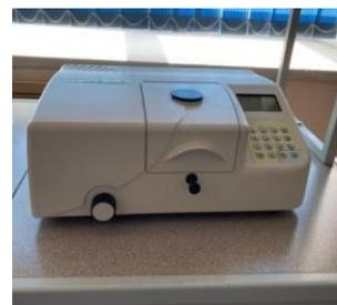
Рисунок 2.4 – Ламинарный бокс ВО-120-PP [115], Термостат ТС-1/80 СПУ [117] и Фотоколориметр КФК-3-«ЗОМЗ»Janway.6300
