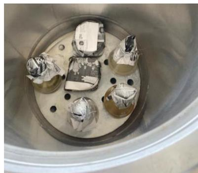
Рисунок 3.1 – Приготовление питательной среды из Czapek Dox Agar и помещение в автоклав
